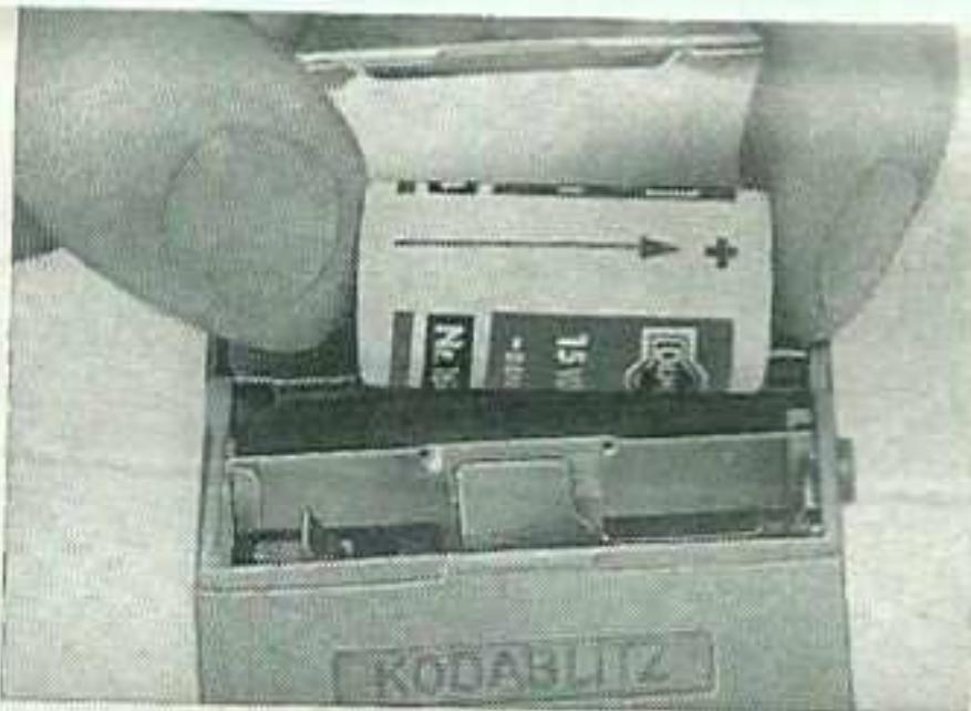
Batterie so einsetzen, daß Plus- und Minuspol mit den entsprechenden Symbolen im Gehäuse übereinstimmen. Beide Deckel schließen.
