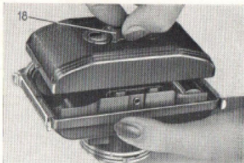
Abb. 5 - Wie der Apparat geöffnet wird: zweiter Handgriff
