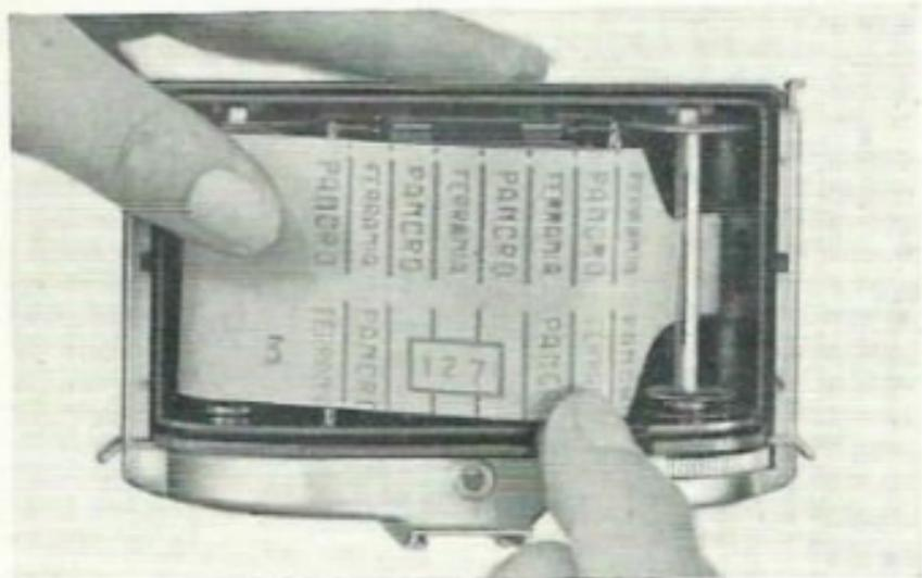
Abb. 9 - Wie das Papierende in die linke Spule eingeführt wird
