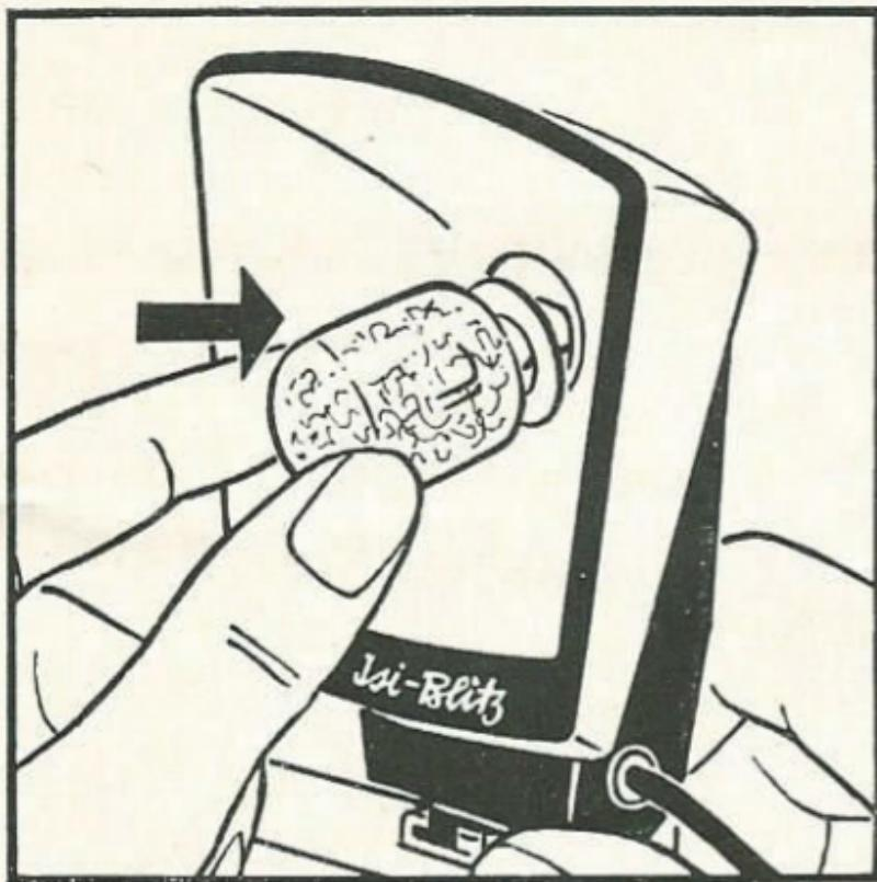
Blitzlampe einsetzen: Kupferdrähte am Glassockel müssen an die seitlichen Kontaktfedern zu liegen kommen. Hierauf Blitzlampe **ohne Drehen** eindrücken.
